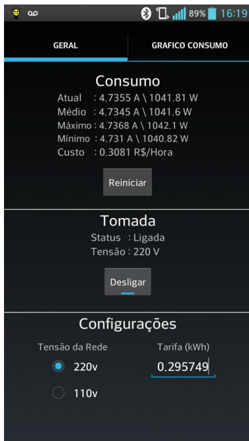
Figura 25 - Tela do aplicativo no teste com ferro elétrico
